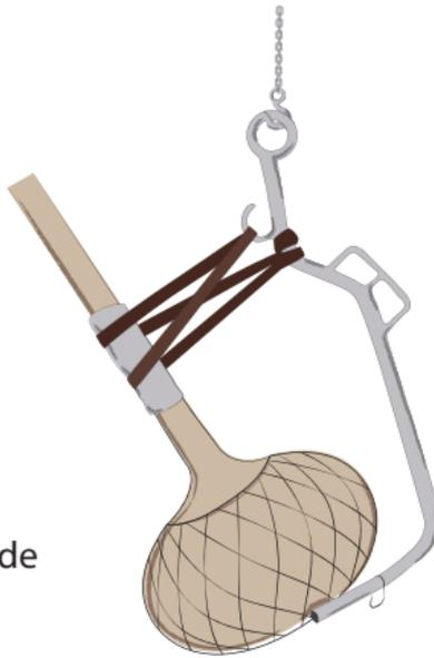
Ballenarm mit seitlich angebrachter Hebeschlinge zum Stamm – eine schonende Methode zum Abladen von Gehölzen und Bäumen.
